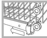
Откройте крепления направляющих корзины справа и слева и выньте корзину. Установите ее сверху или внизу, пропустив ее по направляющим вплотную до входа передних роликов и закройте крепления (см. схему).
