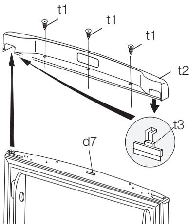
2. Снимите пластмассовую крышечку с пластмассовой декоративной полосы дверцы и установите ее на противоположной стороне (t3).
