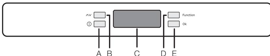
A - Кнопка "ВКЛ/ВЫКЛ" прибора
