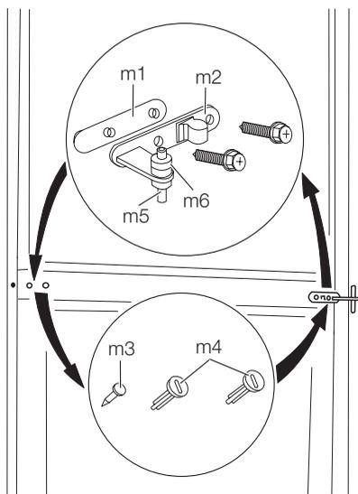
8. Снимите шайбу (m6) и переставьте на другую сторону поворотного штифта петли (m5).
