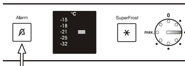
Кнопка выключения звукового предупредительного сигнала
