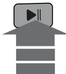
Нажмите кнопку для включения сушки после выбора программы и дополнительных функций. Соответствующий индикатор перестанет мигать.
