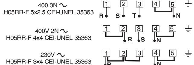
Порядок подсоединения кабеля электропитания:
