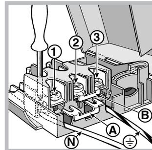
2. установите соединительную перемычку A (см. рисунок) по приведенной выше электрической схеме. Зажимная коробка рассчитана на монофазное соединение 230 В: зажимы 1, 2 и 3 соединены друг с другом; перемычка 4-5
