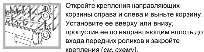
Откройте крепления направляющих корзины справа и слева и выньте корзину. Установите ее вверху или внизу, пропустив ее по направляющим вплоть до входа передних роликов и закройте крепления (см. схему).
