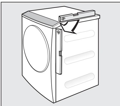
Для обеспечения безупречной работы сушильной машины требуется ее установка в вертикальном положении.
