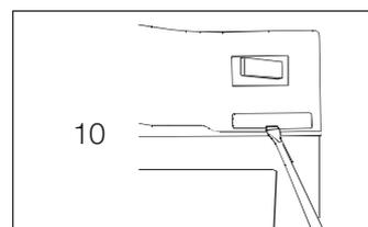
11. Промежуточная балка: выньте пластмассовые заглушки с помощью дорна. Переставьте среднюю петлю на противоположную сторону. Выровняйте вышедшее из отверстий петли волокно и вставьте в отверстия новые заглушки.
