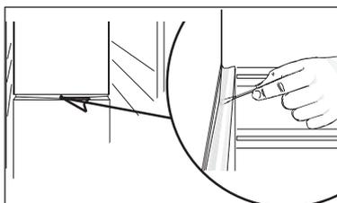
У некоторых моделей сзади имеется звукопоглощающая пластина. Она крепится четырьмя винтами и должна сниматься во время чистки. Прикрепив пластину на место, убедитесь, что она установлена в том же положении.
