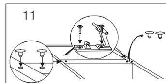
12. Переверните оборудование двери в противоположное положение. Вставьте новую заглушку в отверстие нижней двери.
