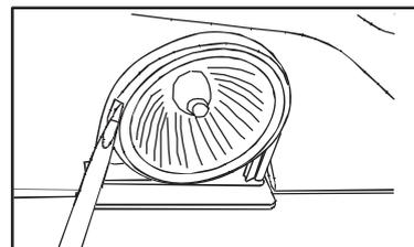
В процессе размораживания использование фена для сушки волос или других нагревательных устройств не допускается. Перегрев может повредить внутренние пластмассовые детали морозильника, вследствие чего вода может попасть на его электрические детали. Это может привести к удару током.
