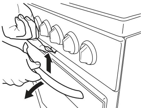
Закройте дверцу, не нажимая на предохранительную защелку.
