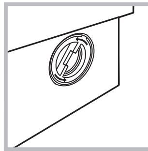
2. выверните крышку фильтра, вращая ее против часовой стрелки (см. рис.): из насоса может выплыть немногого воды — это нормальное явление;
