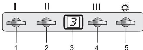
На лицевой панели вытяжки JANNA 3P посередине расположен электронный переключатель режимов работы мотора и ламп освещения (рис. 3). Его элементы имеют следующее функциональное назначение:
