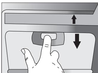
Не устанавливайте фильтр в вытяжку до его полного высыхания. Установка фильтра производится в обратном порядке. Следует нажать на пружинный замок на фильтре и установить его на место, после чего замок отпустить.
