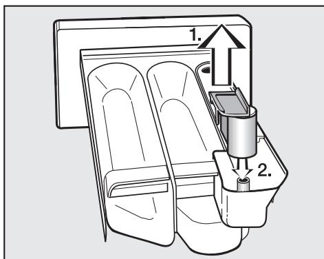
1. Вытяните сифон из ячейки ☀ и промойте под струей теплой воды. Также вымойте трубку, на которой находится сифон.
