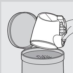
**5** Вытряхните содержимое пылесборника в мусорное ведро. Очистите пылесборник холодной водопроводной водой с добавлением жидкого моющего средства.
