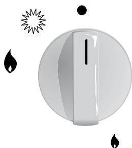
На каждой ручке управления указано, какую конфорку она включает. Рис. 1
