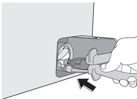
9. Установите на место заглушку отверстия аварийного слива и плотно закрепите ее.
