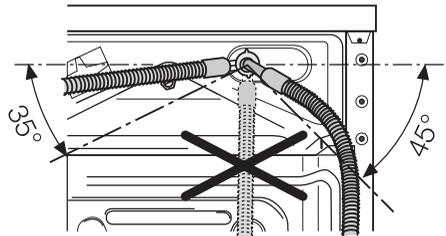
3. Отрегулируйте положение шланга, ослабив зажимную гайку. Отрегулировав положение шланга, не забудьте плотно затянуть зажимную гайку для предотвращения утечек.
