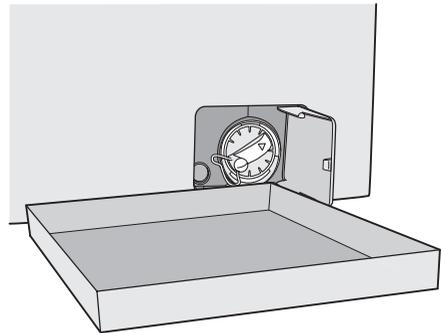
5. С помощью плоскогубцев выньте заглушку отверстия аварийного слива из крышки фильтра.
