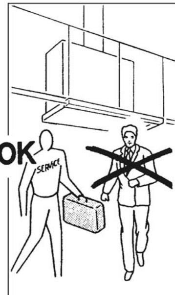
При проведении любых работ по техническому обслуживанию, или если вытяжной вентилятор не используется, выключите питание и отключите прибор от электрической сети. Обслуживание данного прибора должно производиться в авторизованном сервисном центре с применением только оригинальных запасных частей.
