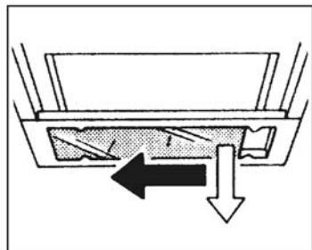
Снимите стеклянный плафон, выдвигая его в сторону. Замените перегоревшую флуоресцентную лампу, либо две обычных лампы.
