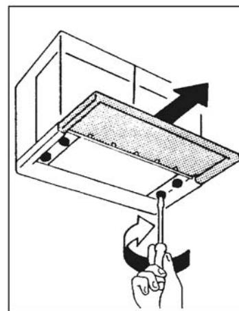
Прикрутите кронштейн блока управления к нижней части корпуса прибора при помощи входящего в комплект винта.
