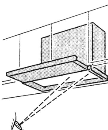
Для демонтажа фильтров нажмите на фиксаторы и снимите фильтры, как показано на рисунке.
