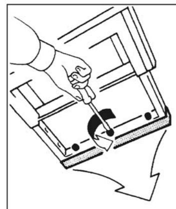
Просверлите отверстия в новой лицевой панели, точно совместив их с отверстиями на корпусе прибора.
