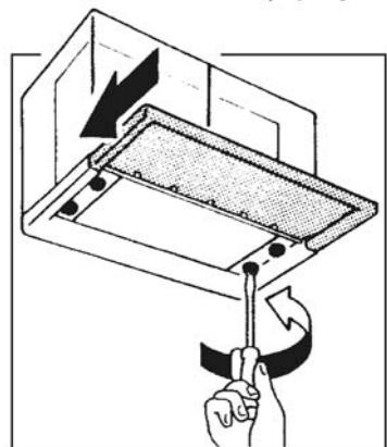
При необходимости выровняйте нижнюю часть вентилятора по горизонтали, ослабив четыре винта и закрыв козырек.
