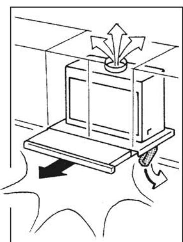
**Вытяжной вентилятор может работать в двух разных режимах:**
