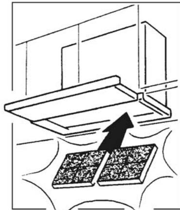
Металлические фильтры необходимо мыть раз в два месяца. Фильтры можно мыть либо вручную в теплой воде с использованием неагрессивного моющего средства или жидкого мыла, либо в посудомоечной машине.
