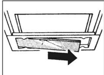
Для замены стартера снимите внутреннюю крышку следующим образом:
