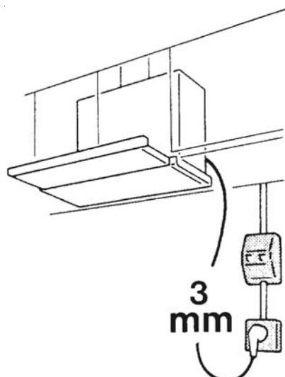
Перед подключением вытяжного вентилятора к электрической сети убедитесь, что напряжение в сети соответствует напряжению, на которое рассчитан прибор и которое указано на фирменной табличке внутри кожуха.
