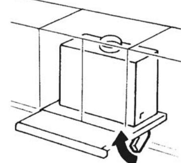
Выдвижной козырек может служить для включения и выключения прибора, если органы управления находятся во включенном состоянии с момента последнего использования.
