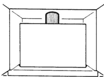
Установите воздушную решетку на трубу и прикрутите решетку к навесному шкафу входящими в комплект винтами. Ребра решетки должны быть наклонены вперед, как показано на рисунке.
