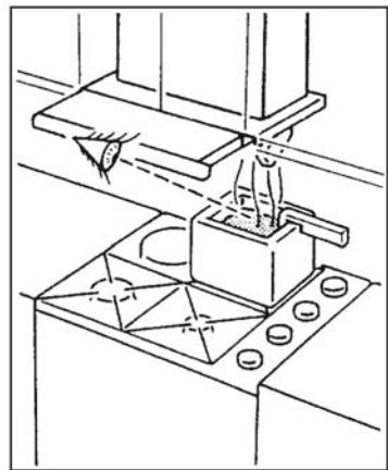
Не следует подсоединять вытяжной вентилятор к воздухоотводам, по которым отводятся продукты сгорания других приборов (от бойлера, камина и т.д.).
