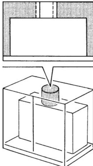
Снизу вставьте верхнюю часть корпуса вентилятора в проделанное отверстие в основании навесного шкафа.
