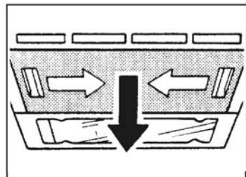
Открутите два винта и поверните крышку вверх.
