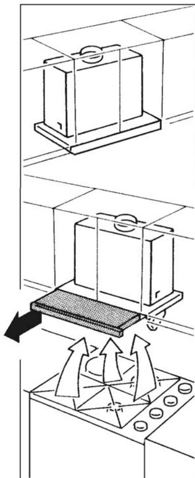
Органы управления прибора находятся в скрытом блоке управления, который можно открыть во время работы вытяжного вентилятора. Если регуляторы прибора установлены соответствующим образом, то выдвигая козырек, можно включить вентилятор.
