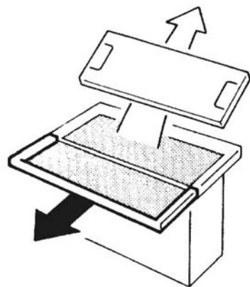
Вытяжные вентиляторы шириной 90 см имеют 4 жировых фильтра, которые снимаются так же, как и фильтры в вентиляторах шириной 60 см.
