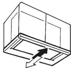
Крепко удерживая корпус вытяжного вентилятора, выдвиньте козырек и затяните крепежные винты.
