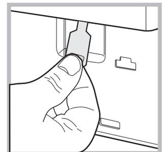
4. потяните наружу язычок, показанный на схеме, вплоть до освобождения пластикового блокировочного винта. Затем потяните его вниз и одновременно откройте люка.
