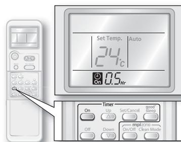
2. Установите желаемое время автоматического включения кондиционера.
