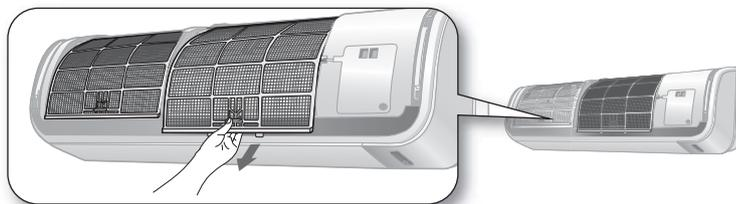
3. Проведите чистку воздушного фильтра при помощи пылесоса или мягкой щетки. Если пыли скопилось много, промойте фильтр в проточной воде и затем высушите в проветриваемом помещении.
