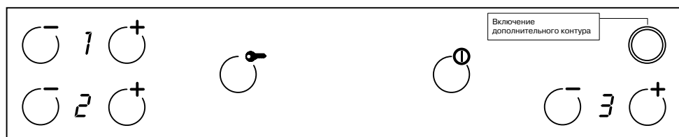
Рис. 15. Панель управления моделями IEC 2413 T/FT, IEC 2623 T
