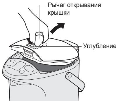
**Нажмите на разблокиратор крыши, удерживайте рычаг открывания крышки и потяните крышку наружу и вверх по диагонали.**
