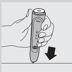
**2** Вставьте отвертку с плоской головкой (обычную) в прорезь в нижней части ручки и поверните ее против часовой стрелки чтобы снять нижнюю крышку.
