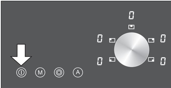
Прикоснуться к главному выключателю **I**. Выдается звуковой сигнал. Индикаторы ступеней варки для конфорок показывают **I**. Теперь варочная панель готова к работе.
