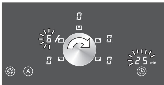
Вы можете использовать встроенный таймер независимо от функций приборов также в качестве сигнальных часов для кухни. Таймер функционирует также при отключенной варочной панели.
