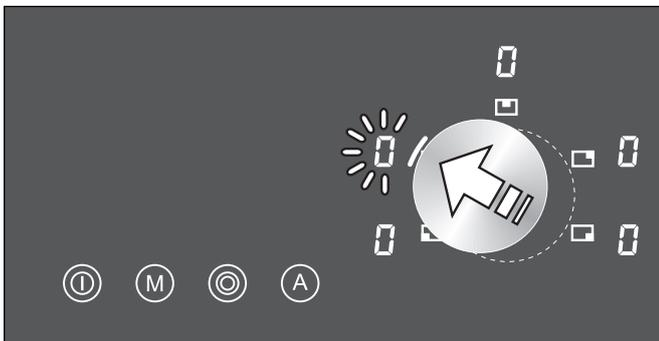
Варочная панель должна быть включена главным выключателем. Включение и выключение всех конфорок производится в одном и том же порядке. Каждая конфорка имеет 9 ступеней с промежуточными ступенями.
