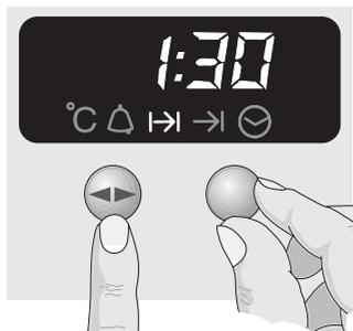
Вы можете включать и выключать духовку с помощью электронных часов.
