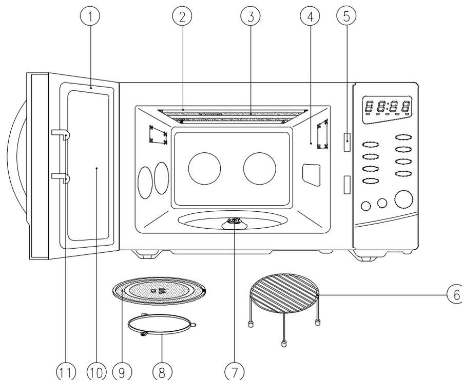
**1. Защелка дверцы** - Когда Вы закрываете дверцу, она автоматически срабатывает. Если дверца открывается во время работы печи, генерирующий микроволны магнетрон автоматически выключается.
