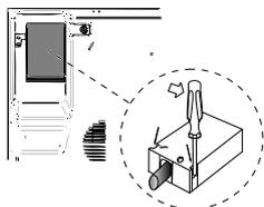
В нижней части изделие оснащено колодкой для подсоединения разных видов электропитания (рисунок приводится для примера и может не соответствовать модели вашего изделия).
