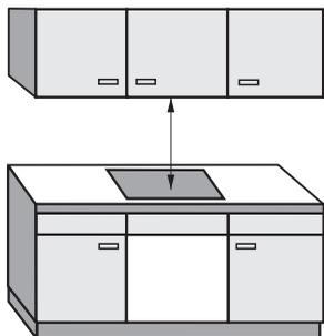
Если для размещения различных приборов под вытяжкой, например, газовой панели конфорок и электрической панели конфорок, в инструкции по эксплуатации и монтажу указаны разные безопасные расстояния, рекомендуется выбирать большее из них.
