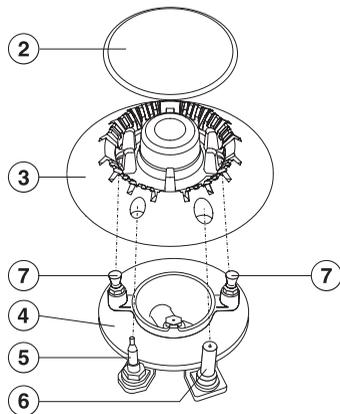
■ Установите головку горелки ③ на основание горелки ④ таким образом, чтобы поджигающий электрод ⑤, термозлемент ⑥ и поддерживающие болты ⑦ вошли в отверстия головки горелки.
