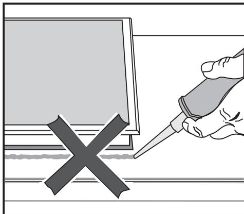
Не используйте никакие герметики, кроме случаев, когда это обязательно требуется. Уплотняющая лента под краем верхней части прибора обеспечивает достаточную герметизацию между прибором и столешницей.
