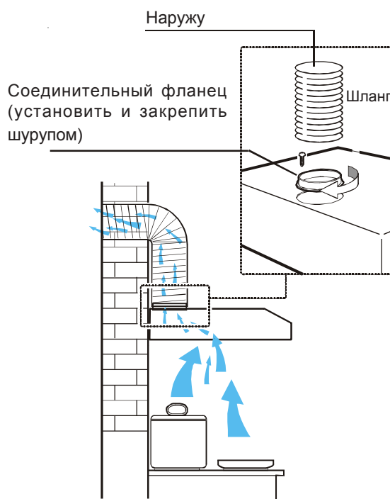
Рис. 1 - Работа прибора в режиме вытяжной вентиляции
