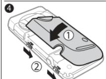
1 Сдвиньте фиксаторы влево и поднимите одну сторону панели аккумуляторного отсека как показано на рисунке. Снимите панель аккумуляторного отсека, повернув ее так, чтобы освободить шарниры на другой стороне панели.
