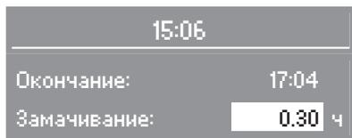
С помощью кнопок **-** и **+** Вы можете ввести нужную продолжительность замачивания. Соответственно этому появится индикация времени окончания процесса стирки. Кнопкой **OK** подтвердите продолжительность замачивания.
