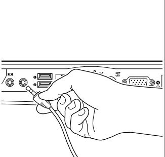
**Шаг 7.** Соедините звуковым кабелем SoundSticks II с компьютером или другим аудио устройством.
