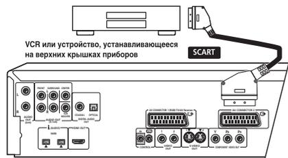
Через разъем **AV CONNECTOR 2** выводится только композитное видео.
