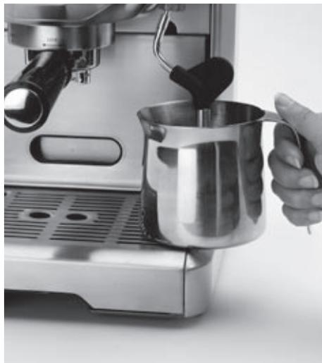
**ПРИМЕЧАНИЕ:** Если оставить устройство включенным, подсвечена будет кнопка, которую нажимали последней. Чтобы включить функцию выброса пара, просто нажмите кнопку Steam (Пар), чтобы включить подсветку этой кнопки, и поверните ручку выбора режима в положение Steam (Пар). Подробнее о кнопках Steam (Пар) и Hot Water (Горячая вода) — на стр. 19.
