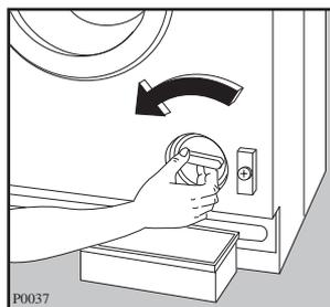
Промойте ее аккуратно проточной водой. Установите сетку на место и закройте крышку.
