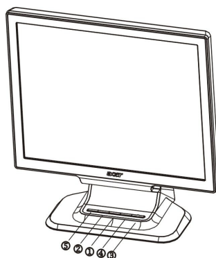
Рис. 3. Наружные кнопки управления
