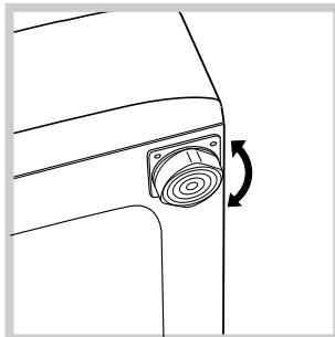
2. После установки машины на место отрегулируйте ее устойчивое положение путем вращения передних ножек (см. рис.). Для этого сначала ослабьте контргайку, после завершения регулировки контргайку затяните. После установки
