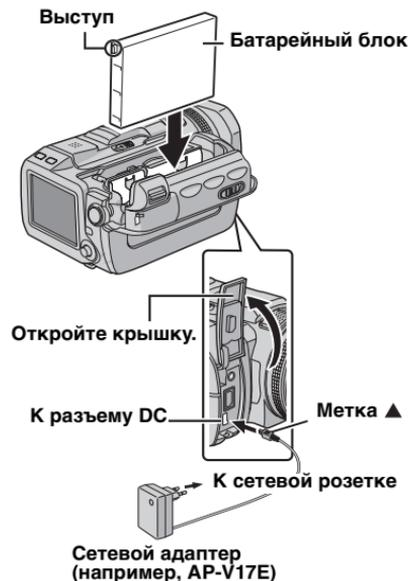
**1** Удерживая нажатой кнопку фиксатора, установите переключатель питания в положение **OFF**.
