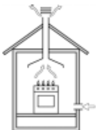
Вытяжка при наличии дымохода (только для кухонного оборудования)
