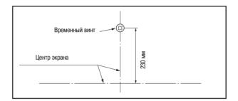
(3) Повесьте узел, который должен крепиться к стене, на винт, установленный в пункте (2).
