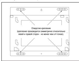
(1) После проверки прочности стены или балки, сначала определите место установки плазменного дисплея, а затем определите место центра экрана.
