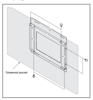
2 Слегка приподняв плазменный дисплей (1), поднимайте его вверх и влево (2) до тех пор, пока он дальше подниматься не будет. Теперь вы можете снять дисплей, потянув его из этого положения на себя (3).
