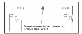
(4) Измерьте расстояние от потолка до металлического узла (А1, А2) и расстояние от металлического узла до пола (В1, В2), выровняйте его, чтобы он был расположен горизонтально, и прикрепите к стене с помощью болтов.
