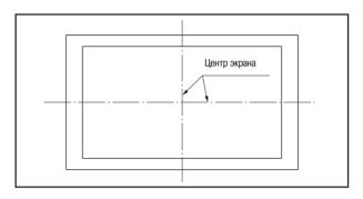
(2) Временно прикрепите винт, используемый для определения положения, который находится в 230 мм выше центра экрана. После того, как металлическая арматура будет зафиксирована, временный винт, если необходимо, можно удалить.
