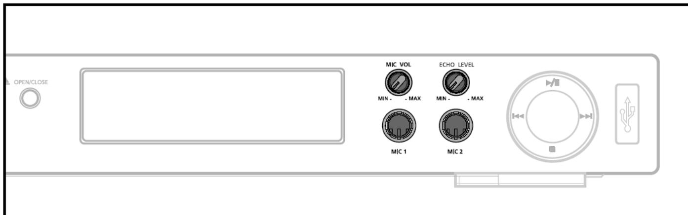
**1** Подключите микрофон к гнезду для микрофона (MIC) на передней панели системы.
