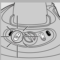
**1** Оставьте прибор подключенным к электросети и убедитесь, что утюг включен. Затем переведите переключатель контейнера-парогенератора в положение «выкл.».
