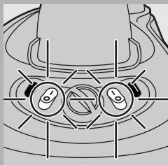
**3** Подключите сетевой шнур к заземленной розетке электросети и установите переключатели контейнера-парогенератора и утюга в положение «вкл.». Контейнер-парогенератор и подошва утюга начнут нагреваться.
