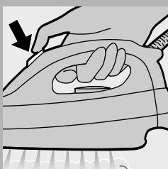
**2** Нажимайте на кнопку парообразования до тех пор, пока вы не перестанете слышать звук пара, выходящего из электроприбора.
