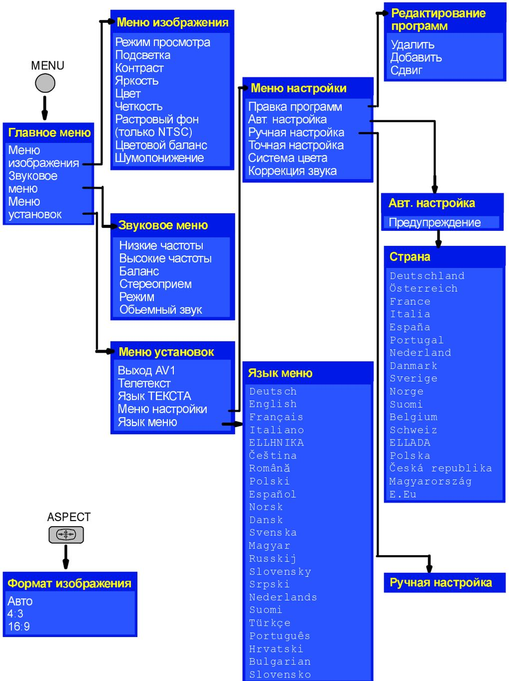
Этот телевизор оснащён обширной системой меню для установки и выбора параметров
