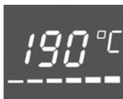
Индикатор контроля за нагревом, расположенный под индикатором температуры, показывает увеличение температуры или состояние остаточного тепла в духовом шкафу.
