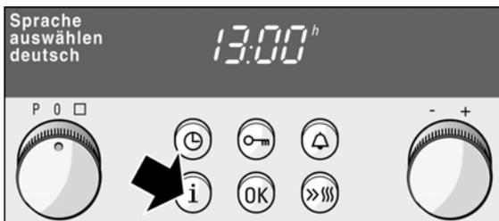
2. Поворотным переключателем измените базовую установку.
