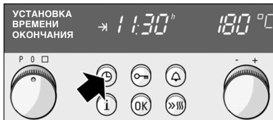
6. Поворотным переключателем измените время окончания на более позднее.
