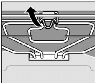
Потяните скобу, удерживающую нагревательный элемент гриля, на себя и вверх до щелчка. При этом придерживайте нагревательный элемент гриля. Затем откиньте его вниз.
