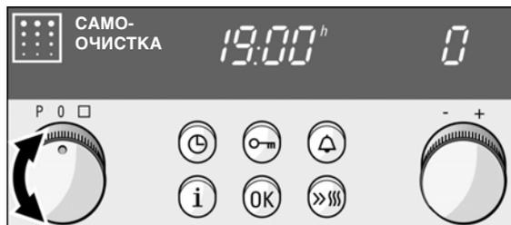
2. Поворотным переключателем установите нужный режим очистки.
