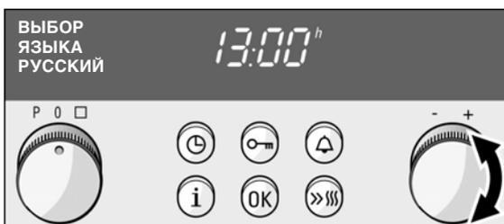
Измените базовую установку, как описано в пункте **2**, и подтвердите ее, нажав кнопку или подождите, пока не появится следующая базовая установка. Произведите таким образом все базовые установки. В заключение нажмите кнопку «OK».
