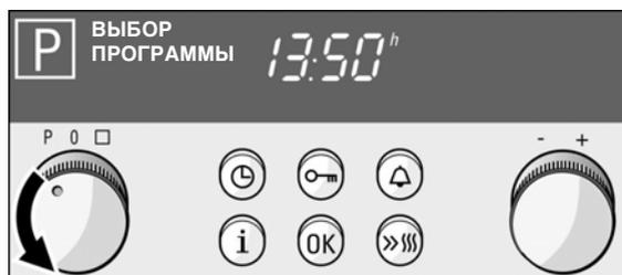
2. С помощью поворотного переключателя установите программу 27.
