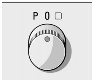
При помощи ручки выбора функций выбирается вид нагрева духового шкафа. Для каждого вида нагрева на дисплее отображается предлагаемое значение.
