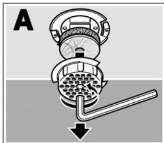
1. Поверните фильтр влево вручную или при помощи шестигранного ключа (6 мм) и снимите его, см. рис. А.
