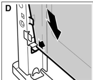
1. Наклоните нижнее стекло и установите его на место (рис. D).
