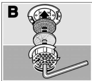
3. Вложите в корпус фильтра однослойный, а затем двухслойный фильтрующий элемент.
