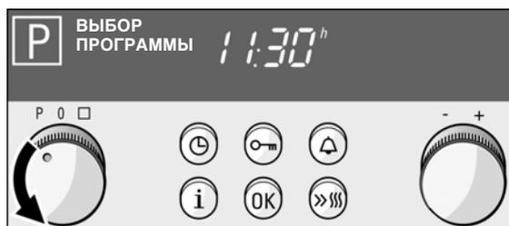
3. С помощью поворотного переключателя установите нужную программу. Подтвердите установку с помощью кнопки «ОК». На дисплее появится текст «УСТАНОВКА ВЕСА».
