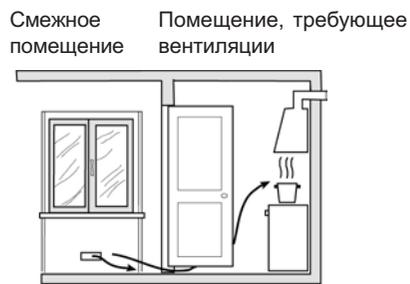
Обеспечение зазора между дверью и полом для свободного прохода приточного воздуха
