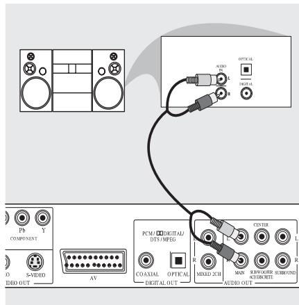
Ресивер имеет декодер PCM, Dolby Digital или MPEG2
