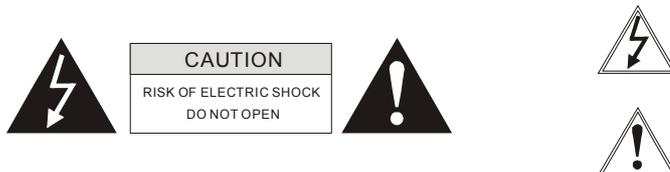
Значок молнии в треугольнике обращает внимание пользователя на наличие опасного неизолированного электрического напряжения, которого может быть достаточно для электрошока.
