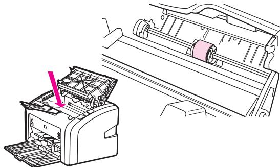
4. Освободите небольшие белые фиксаторы с обеих сторон подающего ролика и проверните ролик вперед.
