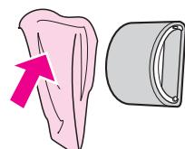
4. Перед установкой ролика в принтер его следует полностью высушить (см. [Замена подающего ролика](#)).
