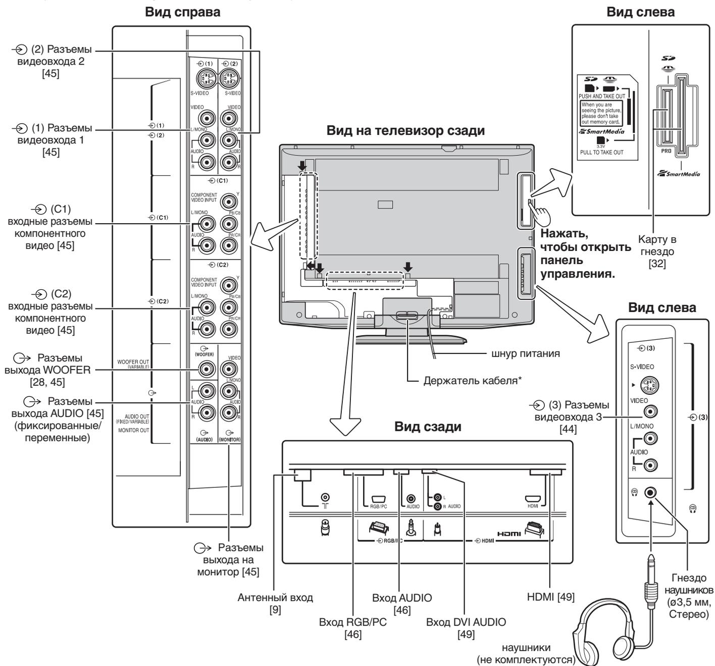
\* Вы можете использовать держатель кабеля для фиксации антенного кабеля, аудио/видеокабелей и т.п. (нажмите на выступ и потяните держатель кабеля).
