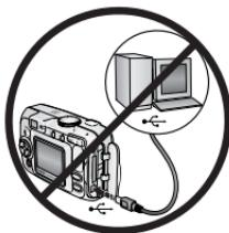
Установите программное обеспечение Kodak EasyShare перед подключением к компьютеру фотокамеры или приобретаемой отдельно док-станции. Невыполнение этого действия может привести к неправильной загрузке программного обеспечения.
