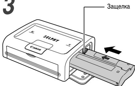
Возьмите кассету тисненой стрелкой вверх и до упора вставьте ее в отсек (в направлении стрелки).
