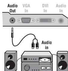
Для подключения комбайнов hi-fi, использовать соединительный шнур аудио и соединить разъемы аудиоразъем **Audio out** телевизора со входами "AUDIO IN" "L" и "R" усилителя.
