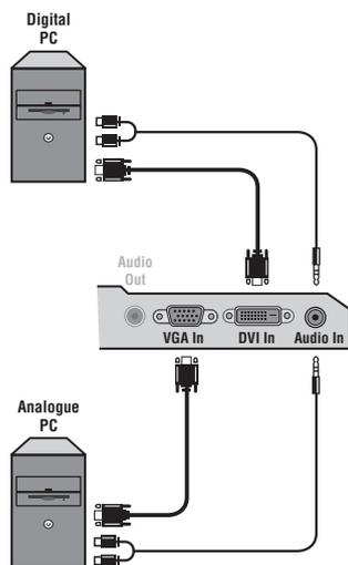
Подсоедините выходной разъем для подключения монитора на компьютере к входному разъему **PC VGA In** или **DVI In** телевизора. Подсоедините выходной аудиоразъем **Audio out L** и **R** на компьютере к входному разъему **Audio in** (PC) телевизора.
