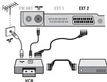
Осуществите указанные на рисунке подключения. Используйте шнур "перитель" хорошего качества. Если у вашего видеомагнитофона нет разъема перитель (или если этот разъем уже занят другой аппаратурой), то возможна лишь связь через кабель антенны. В этом случае вы должны найти тест-сигнал вашего видеомагнитофона и присвоить ему номер программы 0 (см. ручное запоминание, стр. 5). Для воспроизведения изображения видеомагнитофона нажать на клавишу 0.
